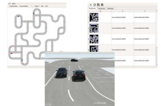
Abb. 3: Screenshots des Automotive Use-Cases: Skizze der virtuellen Teststrecke (oben links), die Testmanöver mit Auswertung im Überblick (oben rechts), ein Szenario als virtuelle Simulation (unten)
